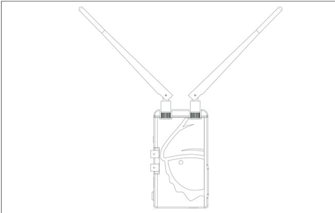
Positioniere die Antennen an Sender und Empfänger wie in der Abbildung gezeigt. Dies gewährleistet die bestmögliche HF-Leistung.
